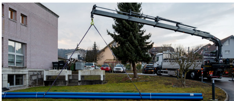
Mit einer Reichweite von fast 13 m ist der HIAB eX.192 E-4 für viele Einsätze geeignet.
