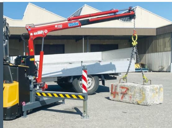
Notterkran Palettenkrane für Flurförder- und Deichselhubwagen sind mit zwei Kranmodellen verfügbar.
