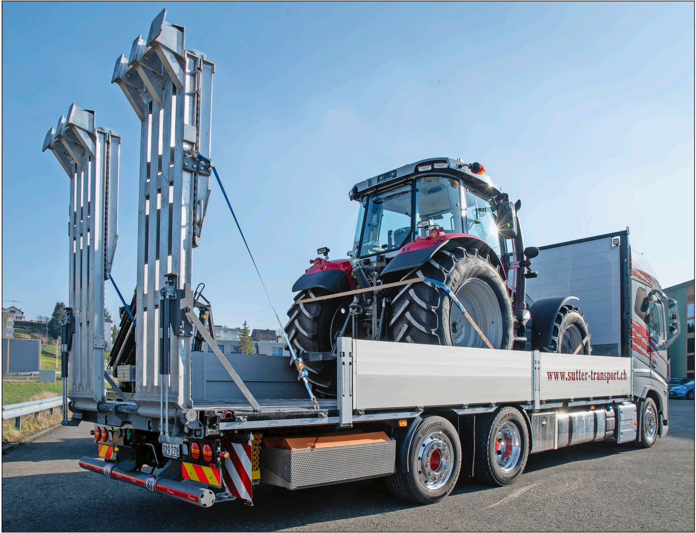
Die Rampen passen wie die zwei HIAB-Krane auch an den neuen Dreiachser, ebenfalls ein Volvo FH und ebenfalls von Notterkran aufgebaut.
