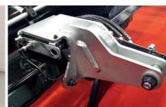
Verrouillage hydraulique monté à l'avant
