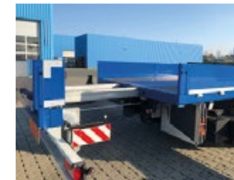
Plateau arrière hydraulique 4 t
