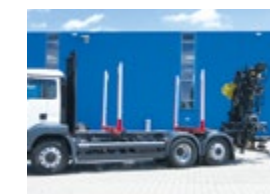
Pont de palettes de poteaux avec grue arrière
