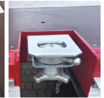
Twist Lock extensible avec NK-Senk
