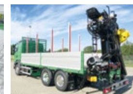
Pont de palettes de poteaux avec charges latérales
