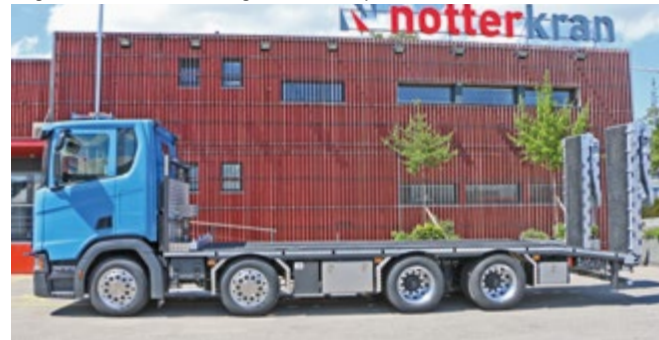
Taxi de chantier avec rampes et treuil hydrauliques
